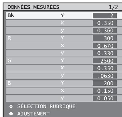
6. Mesurer, à l'aide d'un colorimètre, la luminance (Y) ainsi que les coordonnées trichromatiques (x, y).
